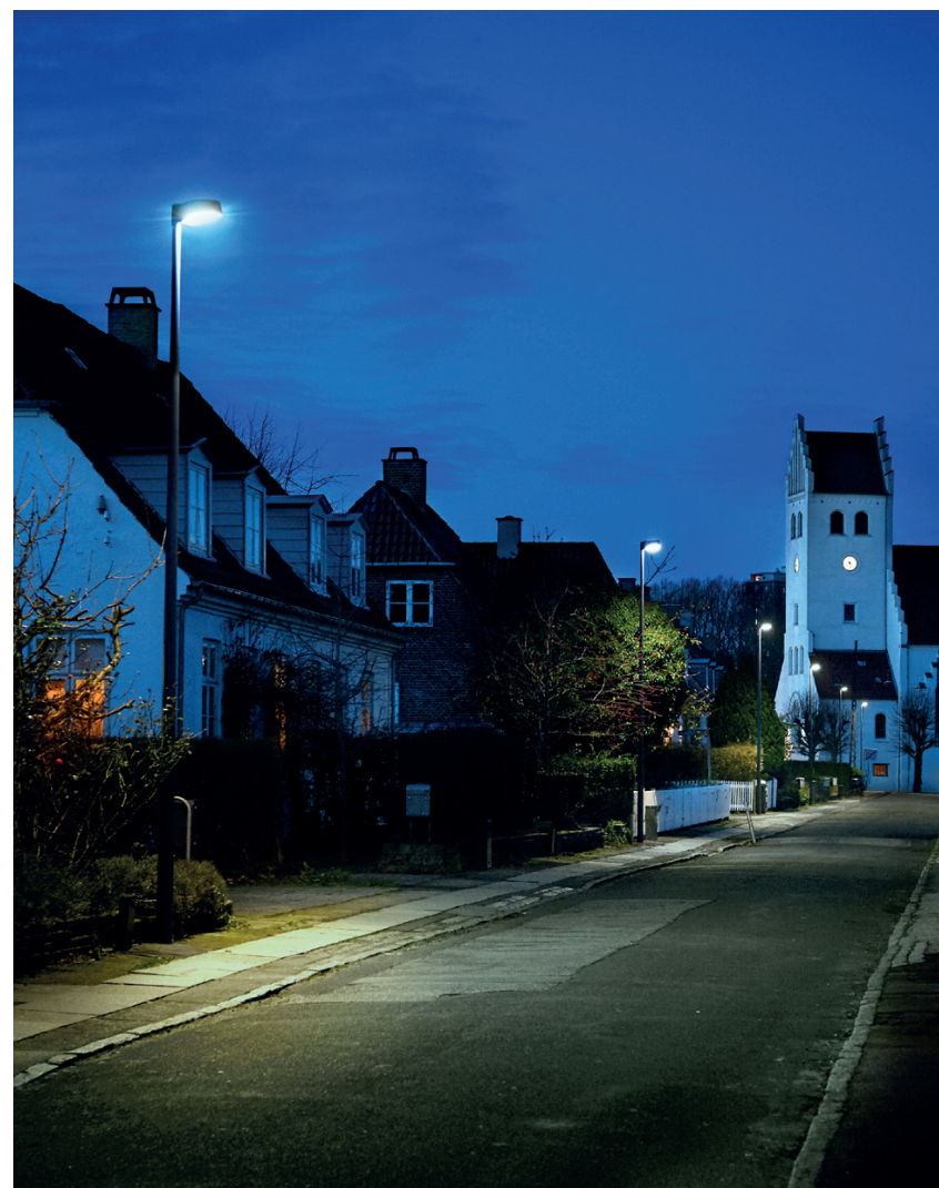
Belysning, mellemhøj moderne lysstander på en smal ældre villavej.
